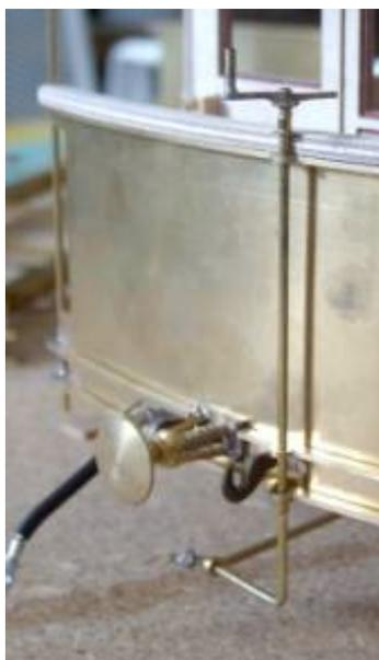
Die Bremsen sind funktionsfähig. Sie sind in der Lage, einen Waggon auch auf einer kleinen Steigung zu halten. Die Bremse wird mit der Kurbel betätigt und mit der Kette fixiert. Spannen Sie bitte die Kette nicht zu stark, da sonst die Anlage verbogen wird. Für den elektrischen Betrieb empfehlen wir die Bremsbacken zu isolieren, um Kurzschlüsse zu vermeiden. Sie können z.B. ein Stück Holzfurnier aufkleben.
