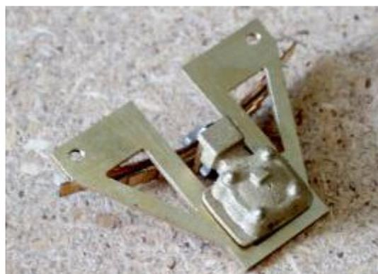
Für die nötige Spannung des Federpaketes nehmen Sie die Kupferplättchen zwischen Daumen und Zeigefinger und ziehen sie ein wenig nach oben. Die Spannung müssen Sie anhand des Federweges ausprobieren. Nun schieben Sie das fertige Bauteil einfach in den Achslagerhalter ein.
