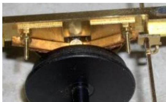
Mit der ersten Mutter befestigen Sie das fertige Bauteil am Fahrwerksrahmen. Die zweite Mutter dient als Auflage für das Federpaket. Diese Mutter drehen Sie nur soweit ein, dass das Federpaket aufliegt. An dieser Stelle fixieren Sie die Mutter mit Klebstoff oder Lot.
