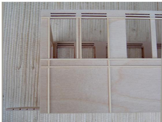
Die 1x1 mm - Leisten dienen zur Verzierung der Seiten. Auf dem Bild erkennen Sie die Anordnung auf dem Wagenkasten der 2. Klasse. Diesem Bild und auch den Abbildungen der fertigen Fahrzeuge auf der letzten Seite dieser Bauanleitung können Sie die Anordnung dieser Leisten für beide Typen entnehmen.
