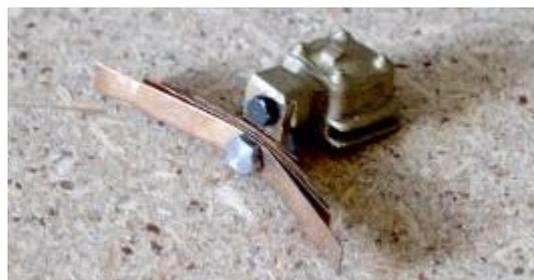
Radlagerhalter, Radlager und Federpakete sind, wie in der Abbildung zu sehen, zu einer Einheit zusammenzubauen und später an den Fahrwerksrahmen zu montieren.
