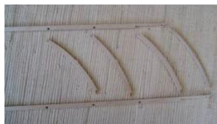
Schneiden Sie aus dem beigefügten Stoff ein Stück für die Bespannung des Daches ab. Verteilen Sie mit einem Pinsel gleichmäßig ein Leim- / Wassergemisch auf der Außenseite des Daches, um Klebewulste zu vermeiden.
