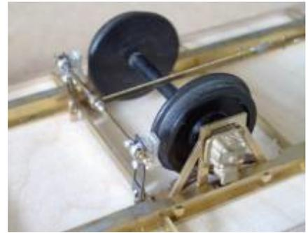
Kurbelstange kurz ca. 7mm an Halterung anlöten, diese dann an der langen Kurbelstange anlöten
